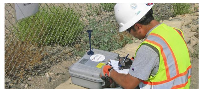
UN TÉCNICO REALIZANDO UNA INSPECCIÓN DE RUTINA EN UNA DE LAS SIETE ESTACIONES DE MONITOREO DEL AIRE.
